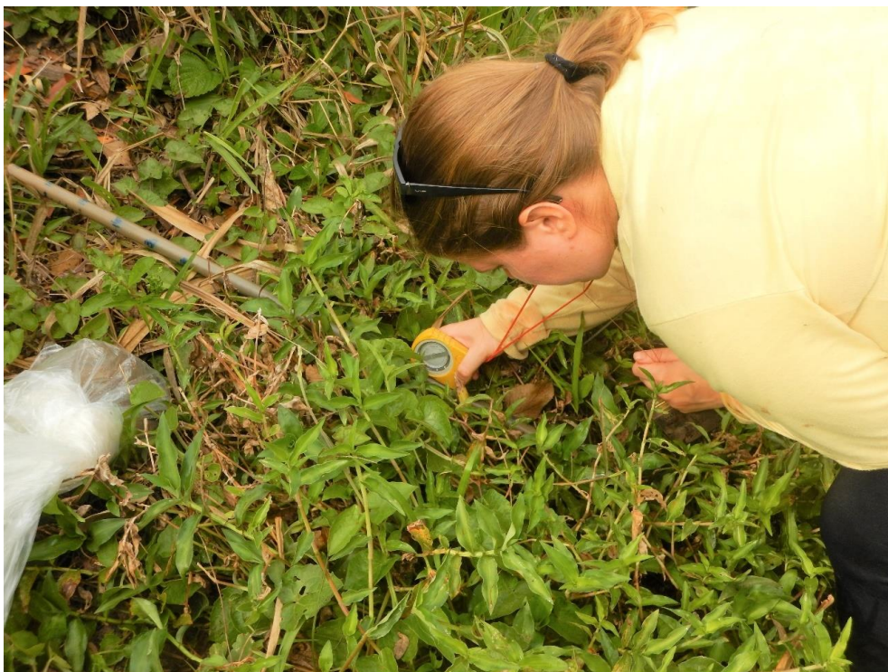
Foto 76: Medição do ângulo da margem através do clinômetro.
