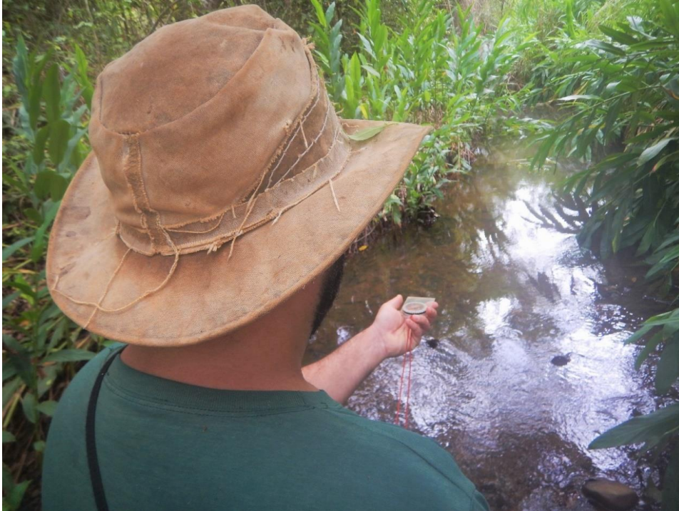
Foto 75: Medição da sinuosidade na seção do canal através de uma bússola.
