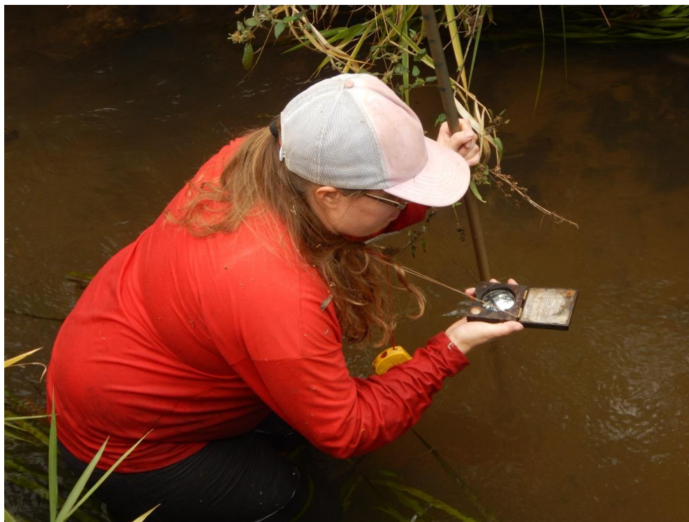
Foto 77: Medição da cobertura vegetal (dossel) através do densiômetro.
