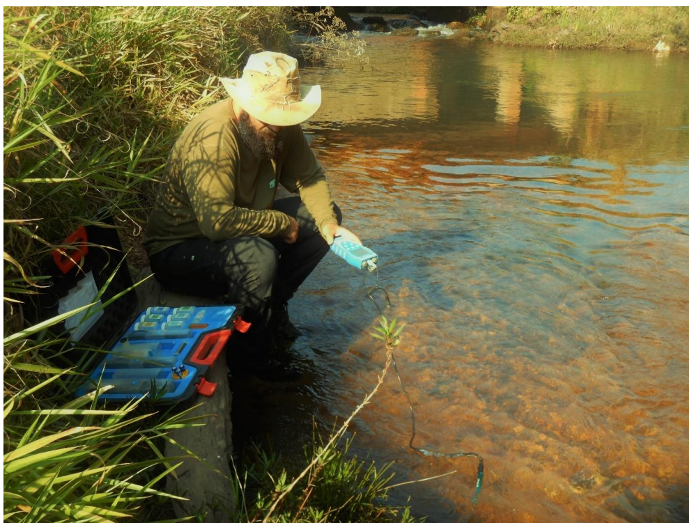
Foto 78: Medição dos parâmetros físico químicos no corpo d'água através de uma sonda multiparâmetros.
