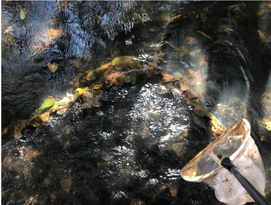
Foto 79: Rede em formato “D” utilizada para coleta de macroinvertebrados bentônicos.
